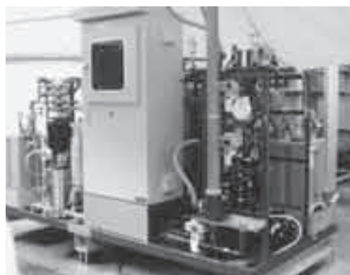
逆浸透膜・汚水処理機
