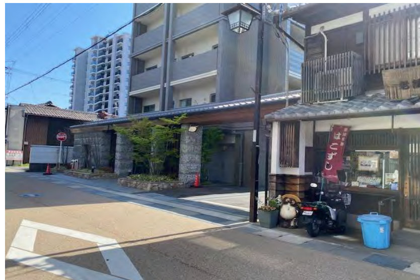
街並みが途切れた区間を庇で 軒線を連続させた例
