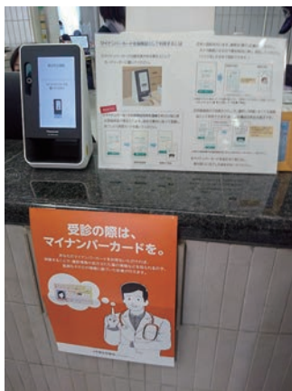
マイナンバー保険証で本人確認をするカードリーダー
