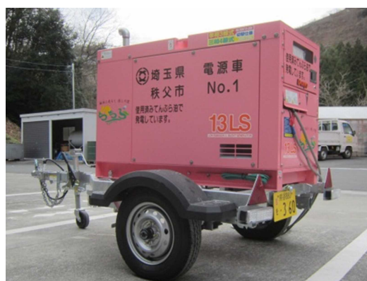
牽引式 BDF 発電機
