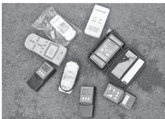
多機種の線量計を比較すると機器の特性がわかる
