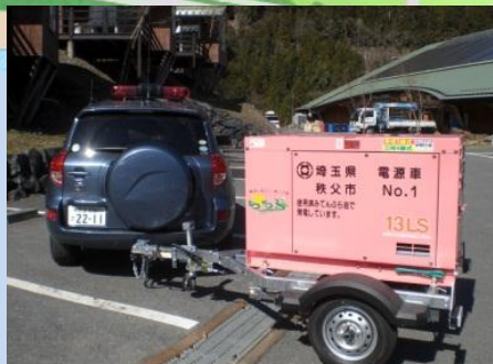
牽引式バイオディーゼル燃料 (BDF) 発電機
